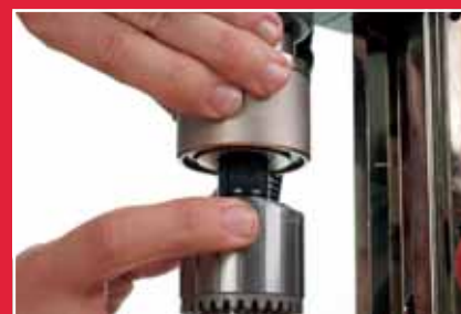
19 mm Weldon Schnellwechselaufnahme
