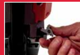
Tiefenanschlag für einfaches Nuten und Falzen
