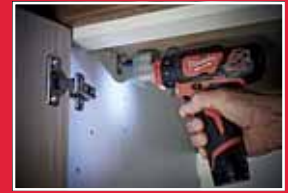
Exzenter Vorsatz für randnahes Schrauben
